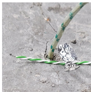
Rys. 2.4: Termopary zamontowane wewnątrz oraz na powierzchni próbki betonowej w celu monitorowania temperatury podczas nagrzewania [60].
