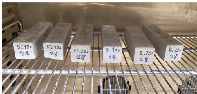
Rys. 2.7: Próbkki umieszczone w komorze grzewczej w celu aktywacji termicznej [59].
