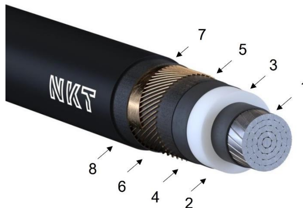
Rys.2.2. Kabel jednożyłowy XUHAKXS na napięcie 12/20 kV firmy NKT o następujących powłokach: 1 – żyła przewodząca aluminiowa, 2 – warstwa półprzewodząca wewnętrzną, 3 – izolacja z polietylenu usieciowanego, 4 – warstwa półprzewodząca zewnętrzną, 5 – uszczelnienie wzdłużne przeciwko wnikaniu wilgoci, 6 – żyła powrotna z drutów miedzianych i taśmy miedzianej, 7 – taśma nieprzewodząca, 8 – zewnętrzna powłoka polietylenowa [62]
