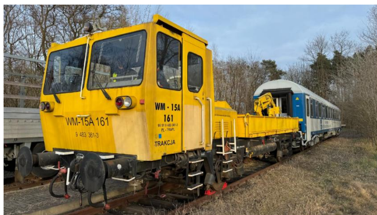
Rys. 6.8. Pojazd WM-15A sprzęgnięty z wagonem pomiarowym typu 150C
