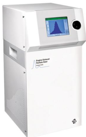
Rys. 6.4. Urządzenie pomiarowe TSI EEPS 3090:
