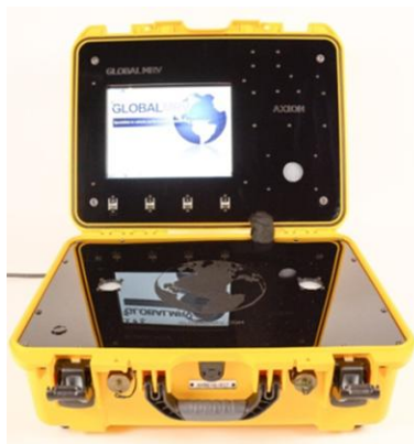
Rys. 6.3. Urządzenie typu PEMS: AXION R/S+™ firmy GLOBAL MRV [102]
