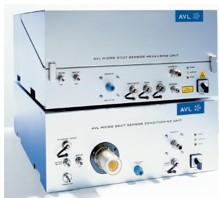
Rys. 6.1. Urządzenie pomiarowe typu PEMS – AVL Micro Soot Sensor [124]
