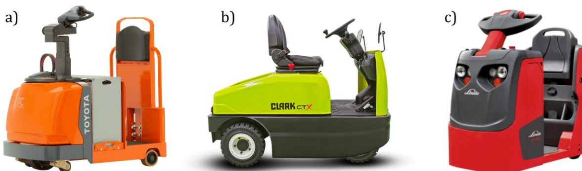
Rys. 1.4. Przykładowe holowniki trójkołowe bez kabiny: a) Toyota (sterowane i napędzane przednie koło) [53]; b) Clark (napędzana tylna oś, przednie koło sterowane) [55]; c) Linde (sterowane i napędzane przednie koło) [54]
