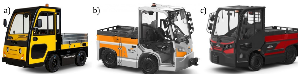
Rys. 1.5. Przykładowe holowniki czterokołowe kabinowe z napędzaną tylną osią: a) Bradshaw [56]; b) Still [57]; c) Linde [58]
