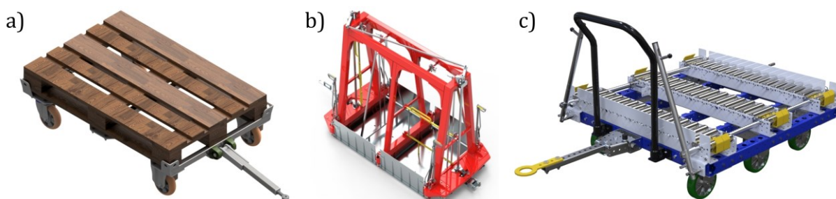
Rys. 1.8. Koncepcje wózków logistycznych: a) koncepcja przyczepy; b) koncepcja taksówki [68]; c) koncepcja przenośnika rolkowego [69]
